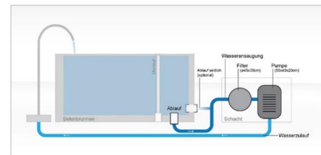
Schema Technikeinheit gross / Pool technique scheme
